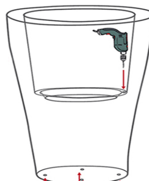
Bohrlöcher für unbeleuchtete Pflanzgefäße bei Outdoor-Einsatz Drill holes for unlit planters for outdoor use Trous de forage pour les jardinières non éclairées en cas d'utilisation en extérieur Fori per fioriere non illuminate da esterno Taladros para jardineras sin iluminación para exteriores Wiercenie otworów pod niepodświetlane donice do użytku zewnętrznego
